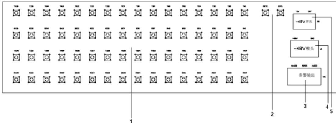
图2.3 直流-48V的SD732后面板组成
