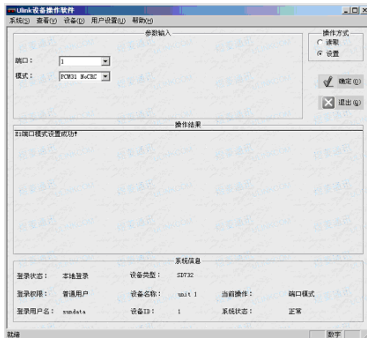
图5.1 E1中继端口的帧模式设置界面
